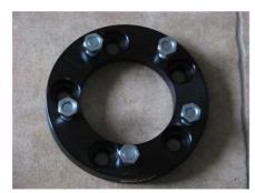
Description ÉPAISSEUR: 38 mm NOMBRE DE BOULONS: 5 ESPACEMENT ENTRE LES BOULONS: 130 mm
